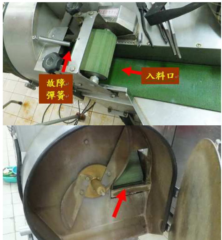
圖 2 勞工手指遭切菜機刀具砍斷
